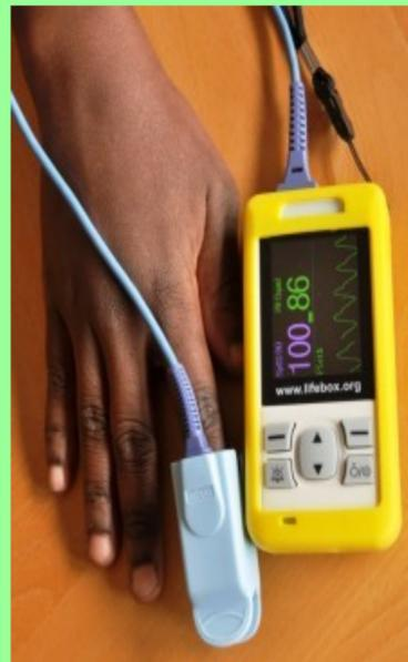
Figure : Lifebox Oximeter<sup>21</sup>
